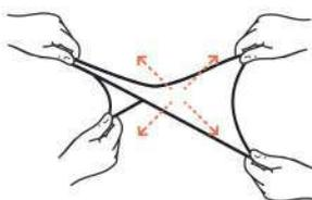
Las fibras elásticas de Elastano son usadas para darle elasticidad al tejido. Los tejidos elásticos en 4 direcciones tienen elasticidad en la trama, elasticidad en la urdimbre y elasticidad bidireccional para máxima flexibilidad.
